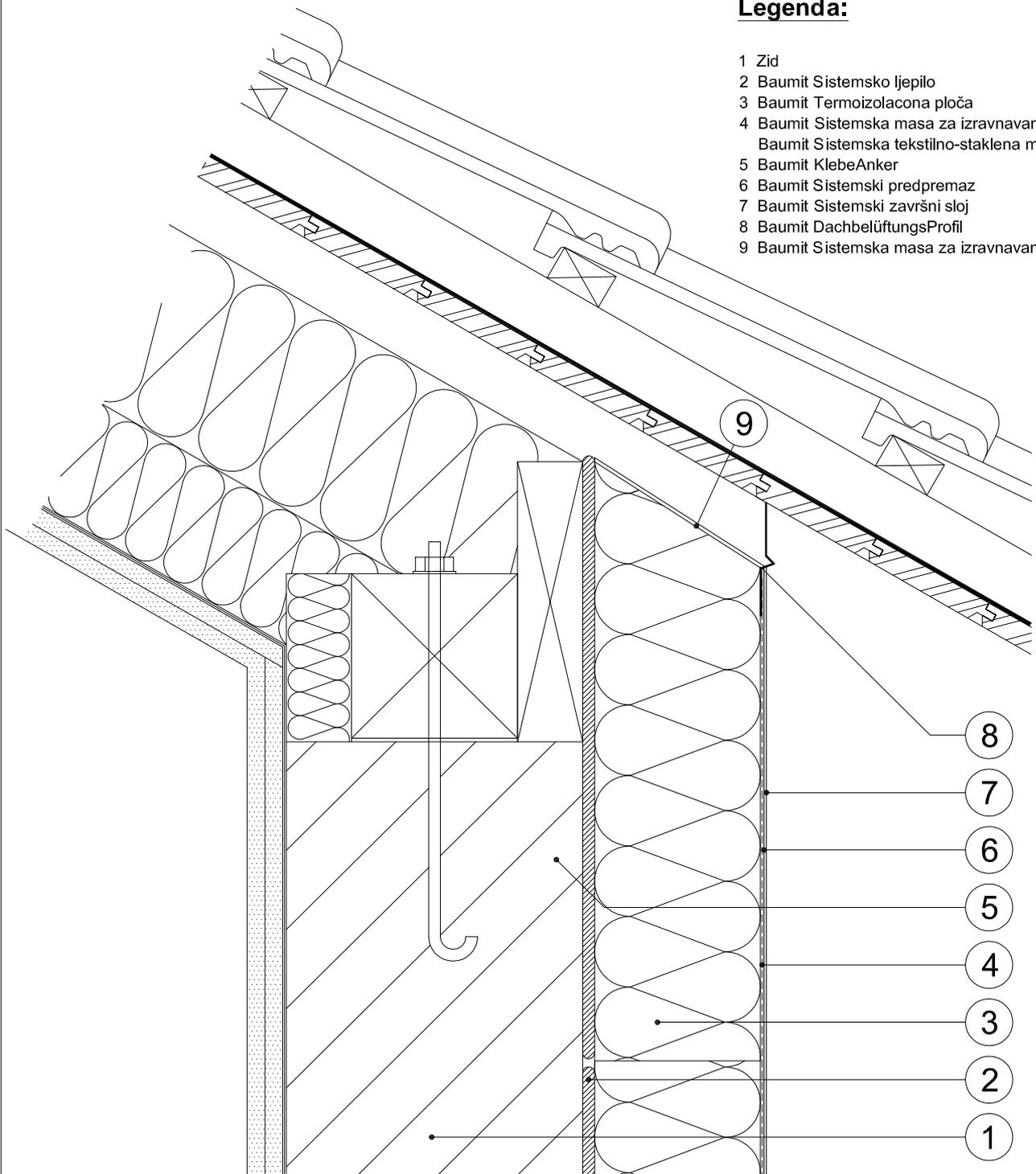
Na području spoja sa kosim krovom preporučuje se da se završni red termoizolacionih ploča postavi metodom obostranog ljepljenja, a nakon toga donji red izolacionih ploča na uobicaeni način. Da bi se spriječila pojava toplotnih mostova u području spoja sa kosinom krova, neophodno je odgovarajuće upasovati završni red izolacionih ploča. Postavljanjem metodom obostranog ljepljenja će se izbjeći pojava efekta kamina i iz toga nastajuća pojava kondenzata.
