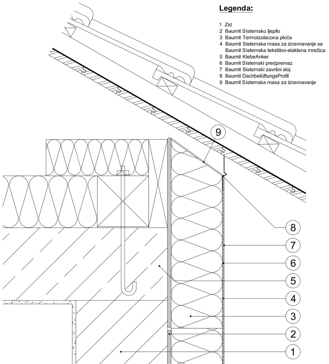
Na području spoja sa kosim krovom preporučuje se da se završni red termoizolacionih ploča postavi metodom obostranog ljepljenja, a nakon toga donji red izolacionih ploča na uobicaeni način. Da bi se spriječila pojava toplotnih mostova u području spoja sa kosinom krova, neophodno je odgovarajuće upasovati završni red izolacionih ploča. Postavljanjem metodom obostranog ljepljenja će se izbjeći pojava efekta kamina i iz toga nastajuća pojava kondenzata.
